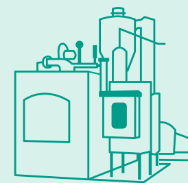
<木質チップ炊き蒸気ボイラー> 3,762kW1台
