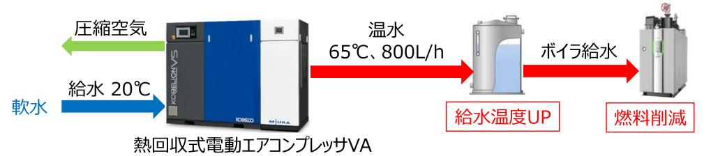
VA-750CO(37kW) の場合、回収熱量は都市ガス3.9m3N/hに相当します
